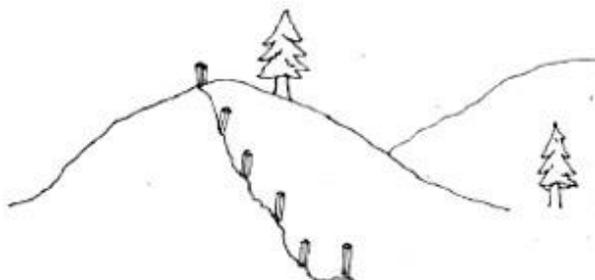
2 Para trazar nuestra primera línea, se coloca una pata del lado de “arriba” de una estaca de la línea madre, moviendo la otra pata, se busca la posición donde la plomada coincida con la línea del centro del travesaño, se clava una estaca del lado de “abajo” de la pata
