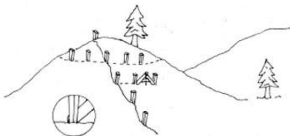
3 Se da media vuelta al aparato girando sobre la segunda pata, nuevamente buscamos el punto de nivel de la primera pata y clavamos una estaca en el lado de abajo.
